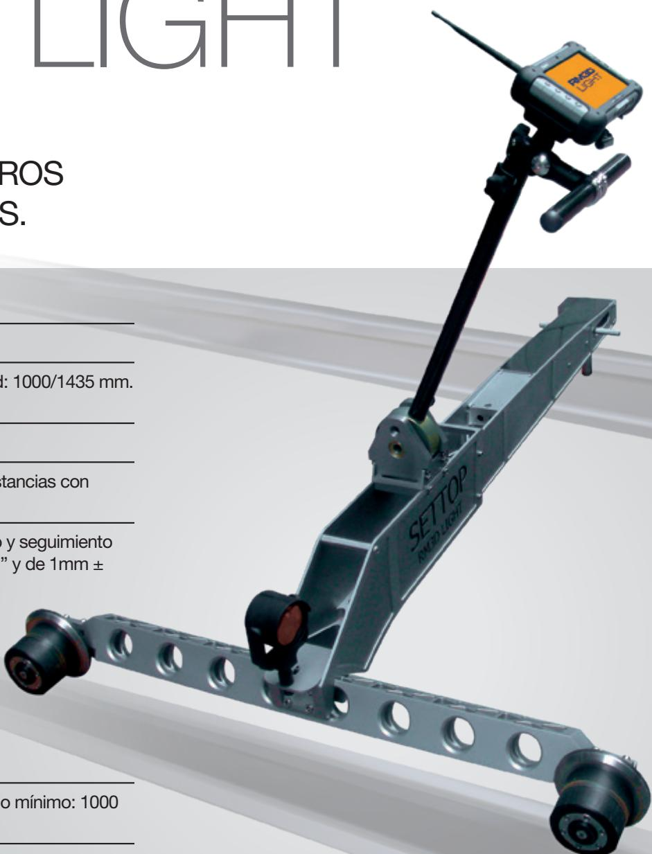
**TOMA DE DATOS:** Se utiliza para realizar levantamientos de la vía y saber el estado actual de ésta. Puede tomarse en modo Absoluto (necesario Estación Total) o Relativo (únicamente con el útil).
